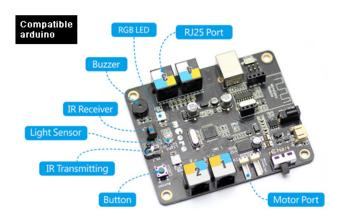
La platine dispose d'une prise USB afin que vous puissiez la programmer via l'environnement de l'arduino. Elle dispose également:
